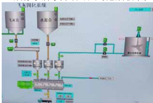
飞灰稳定化 PLC 系统
